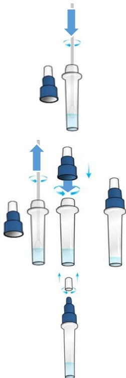
1. Abrir el **vial pre-dosificado con diluyente para muestra**, e introducir inmediatamente el hisopo con la muestra correspondiente, con cuidado de no contaminar ninguna superficie exterior con la muestra.
