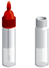
1 Tubo para la dilución de la muestra
